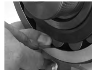
Fig. 15. Durante el montaje, el RIC debe controlarse en el rodillo sin carga.
