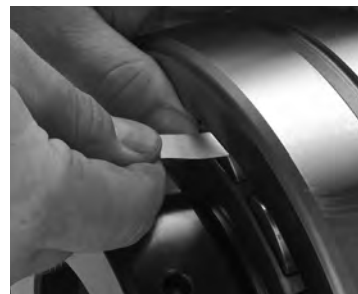
Fig. 18. Medida del RIC antes de la instalación.
